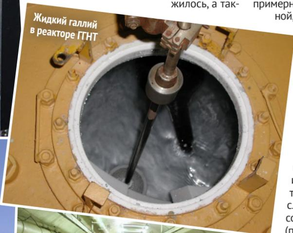
Жидкий галлий в реакторе ГГНТ
