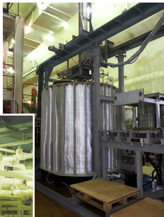
Уникальный двухзонный детектор, вмещающий 50-тонную галлиевую мишень, в лаборатории ГГНТ БНО ИЯИ РАН. Этот детектор — один из основных аппаратов эксперимента BEST, упомянутого в лиде материала
