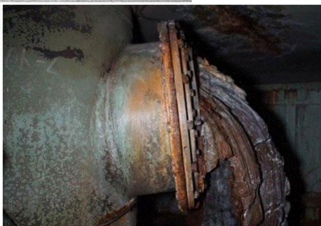
Фото 6. Застывший поток лавы, вытекающей из трубы (паросбросного клапана) в парораспределительном коридоре в «Саркофаге» (объекте «Укрытие») в помещении 210/7. Фото сделано сотрудниками Курчатовского института, предположительно в 1990 году
