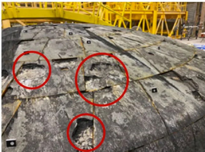
Повреждение теплозащитного экрана космического корабля Orion в ходе миссии Artemis I. Отчет Управления генерального инспектора NASA. Фото: NASA OIG
