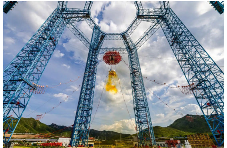
Посадочный модуль «Ланьюэ». Испытания на полигоне в провинции Хэбэй, Северный Китай. Фото: CMSEO
